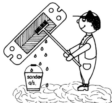
Rostfreier Stahl hat einen passivierten (schützenden) Film. Dieser Film darf nicht zerstört werden, da der Film dazu beiträgt, die Korrosionsbeständigkeit zu bewahren.
