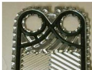
**Linksgängiger Durchfluss mit Dichtung**
